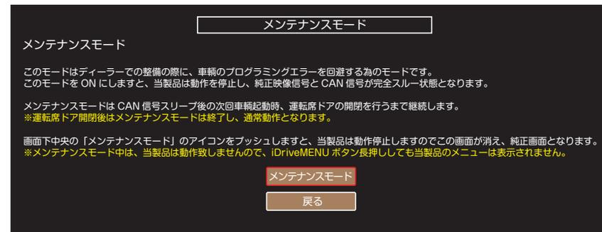
※VEMメニューからの操作以外にiDriveコントローラーのMENUボタン10秒間長押しでもダイレクトにメンテナンスモードに突入する事が出来ます。
