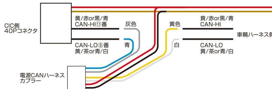
新型車両ではCAN信号配線色が変更されています。40Pコネクタのピン番号で確認して下さい。
